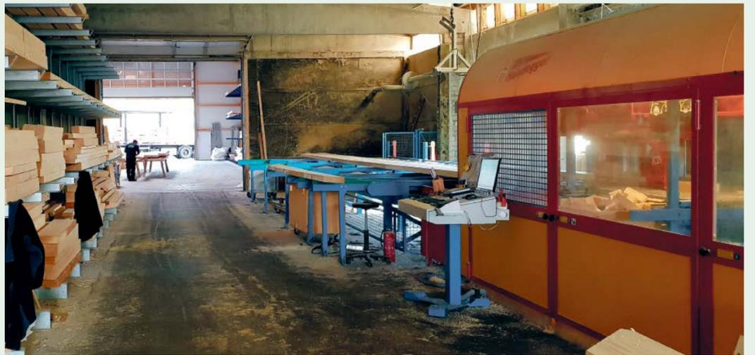
Der Zuschnitt im Holzbau läuft meist automatisiert. Die entsprechenden Daten werden digital an die Maschinen übergeben, wie hier
